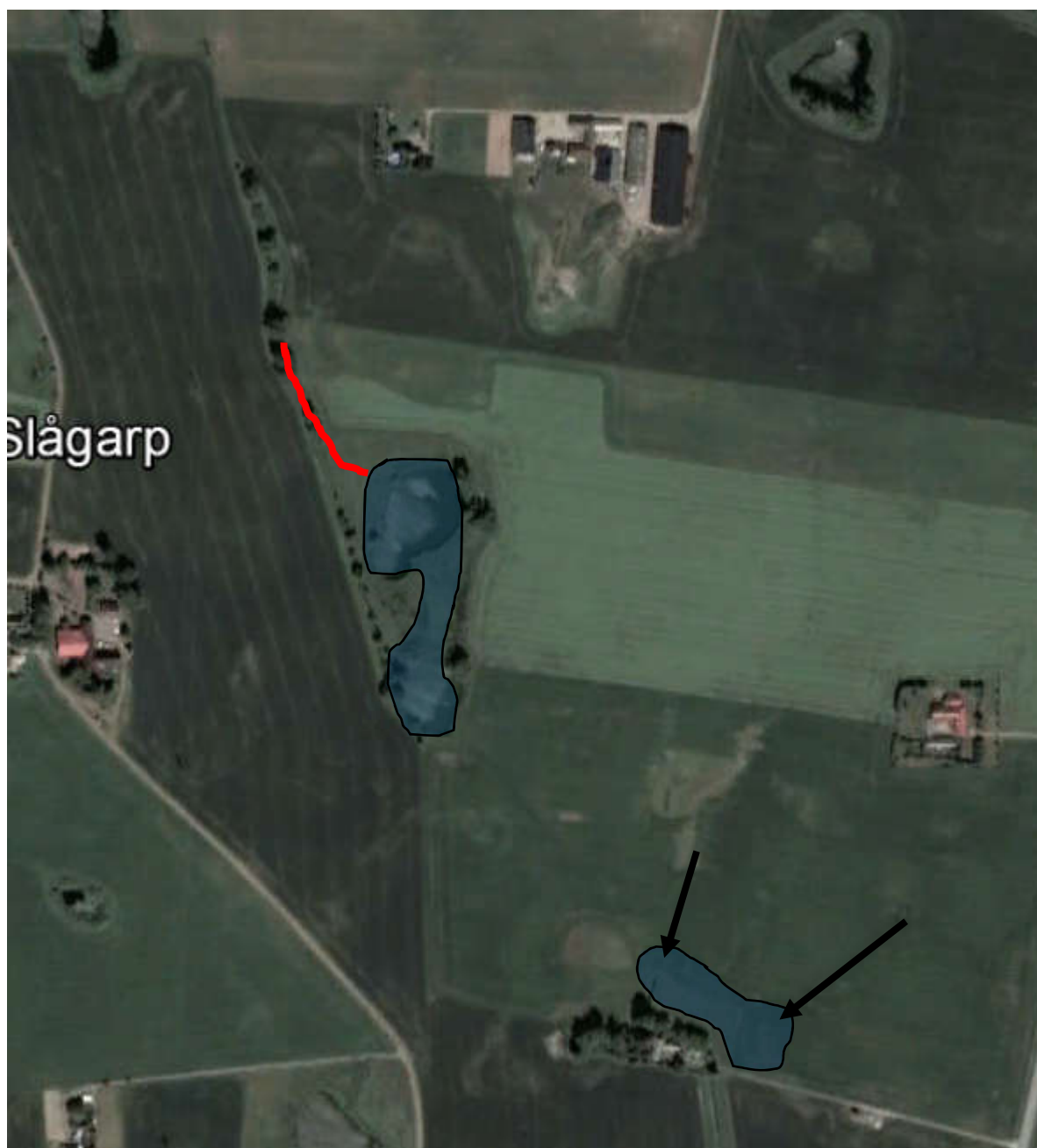
Figur 15 Röd = tvåstegsdike, blå yta = anläggning av våtmark
