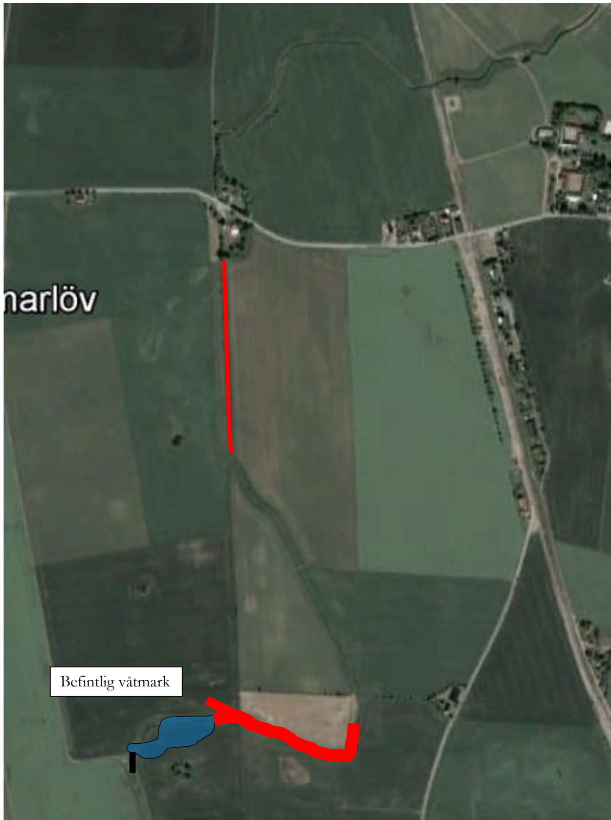
Figur 11 Röd norr = tvåstegsdike, röd söder = brett tvåstegsdike/översvämningszon som sammankopplas med våtmark, Befintlig våtmark = restaurering genom borttagning av sediment, Svart = Ta bort nedre bron och förstärkning av övre
