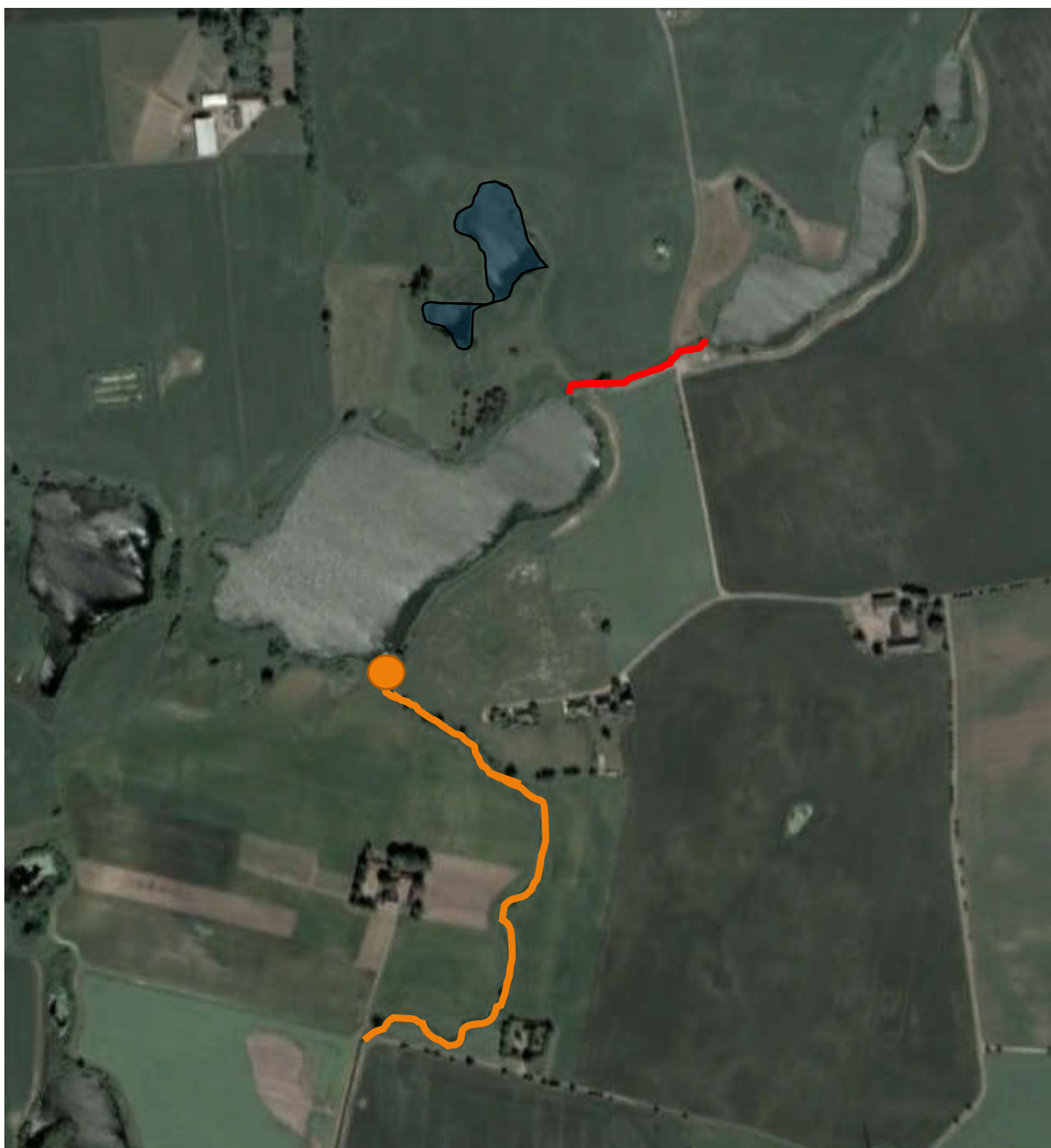
Figur 13 Röd = tvåstegsdike, orange streck = meandring, blå yta = bef. våtmark restaurering, gul ring = vandringsbinder med ev. åtgärd
