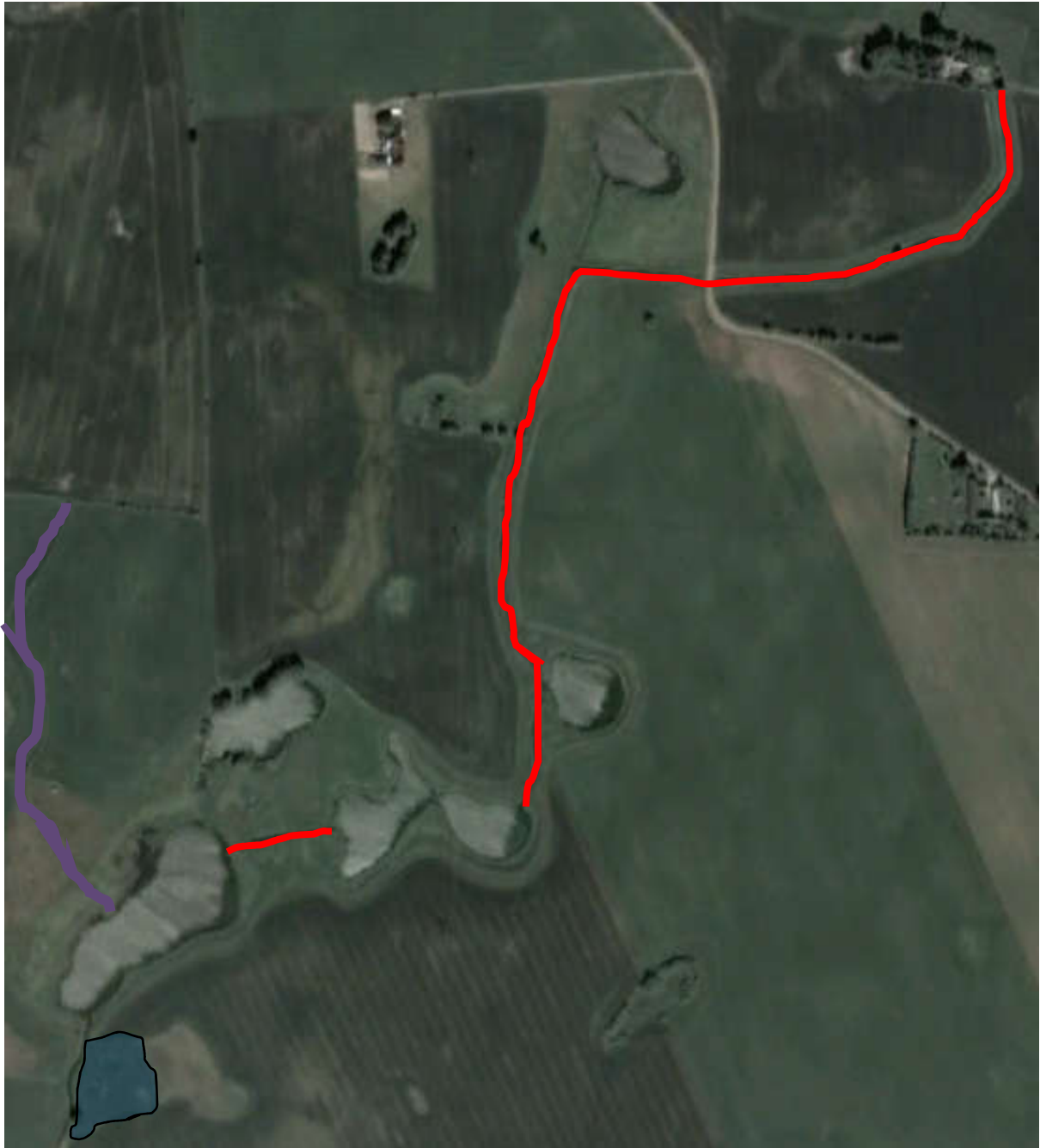
Figur 14 Röd = tvåstegsdike och meandring, blå yta = bef. våtmark restaurering, Lila = Kantavplaning, insatser med sten och grus i botten samt trädplantering längs ena sidan
